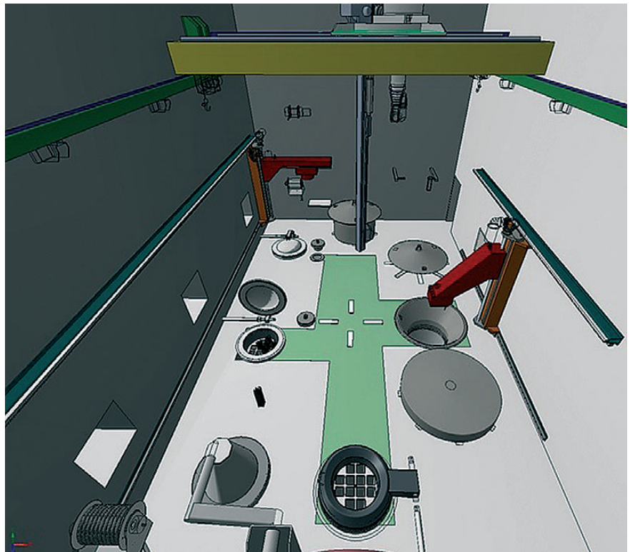
Kuva 6. Polttoaineen käsittelykammio kapselointilaitoksesta. Etualalla kapselin telakointiasema, vasemmalla polttoaineen kuivausasemat ja oikealla kuljetussäiliön telakointiasema. Ylhäällä polttoaineen siirtokone.
