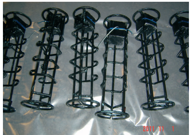
Kuva 18. Betonikoe-kappaleita todellisista kallio pohjavesi-olosuhteista poistettuina näytteenottoa varten teräksisissä näyttekoreissa.
