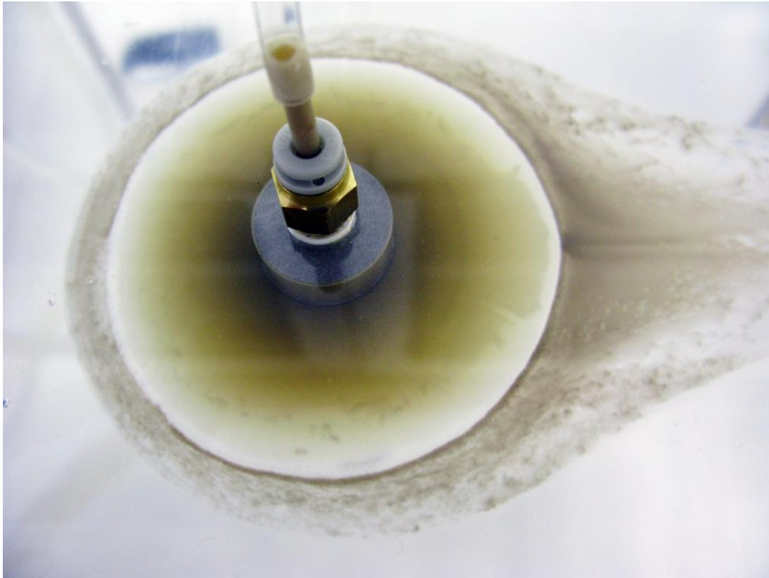
Kuva 5-7. Koelaitteen keskellä oleva bentoniittinäyte on erodoitunut kemiallisesti 1 mm raossa muodostaen ilmiölle tyypillisiä vaihtumisvyöhykeitä.
