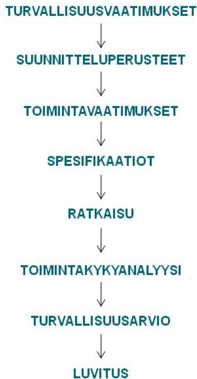
Kuva 6-2. KBS-3-ratkaisu. Kuvassa on esitetty tutkimus-, kehitys- ja suunnittelutyön kulku sen kehittämiseksi ja turvallisuuden osoittamiseksi luvitusta ja edelleen toteutusta varten.
