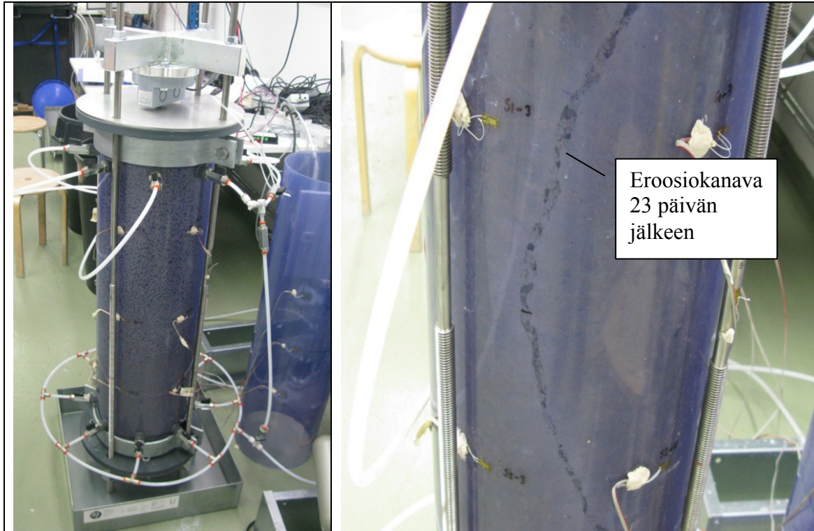
Kuva 5-3. Eroosionopeutta mittaava koejärjestely. Kokeessa mitataan lisäksi mm. kanavan pituus ja leveys. Kuvien kokeessa veden virtaama on 0,1 l/min ja liuoksen suolaisuus 10 g/l (NaCl).
