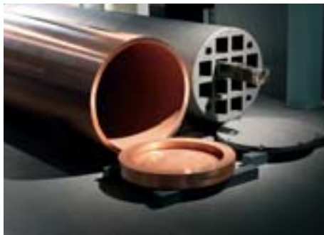
Olkiluoto 1:n ja 2:n polttoaineelle suunnitellun loppusijoituskapselin sisäosa ja ulkokuori
