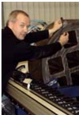
Loppusijoituskapselin sisäosan ultraäänitarkastus
