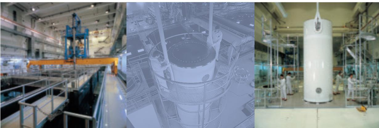
*Вес массивного транспортировочного контейнера при полной загрузке достигает 93 тонн.*
