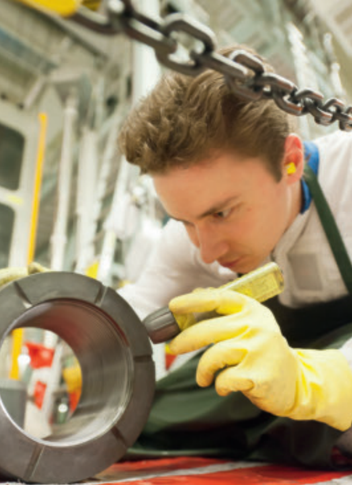
Alstom Finland Oy:n Tomi Siromaa tarkasti reaktoritankin kannen holkkien kunnon.
