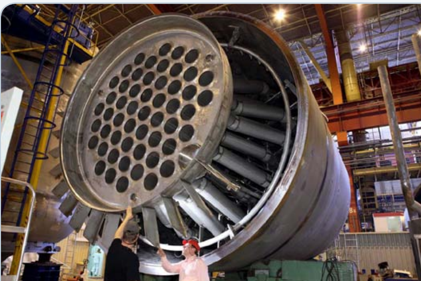
Höyrystimen sekundääripuolen sisäosia asennusvaiheessa tehtaalla Ranskassa.
