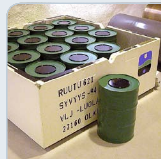
Kiinteät voimalaitosjätteet pakataan 200 litran tynnyreihin ja betonilaatikoihin.
