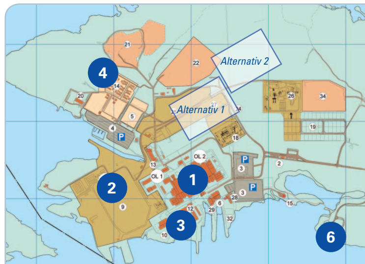
Bild 3. Olkiluotoverkets område. Kartan visar bl.a. OL1 och OL2 (1), OL3-bygget (2), mellanlagret för använt kärnbränsle (3), slutförvaret för driftavfall (4), slutförvaret för använt kärnbränsle, arbetsplatsen vid det underjordiska forskningsutrymmet (5) och besökscentret (6). Kartan anger också de alternativa placeringarna för den nya kärnkraftverksenheten.
