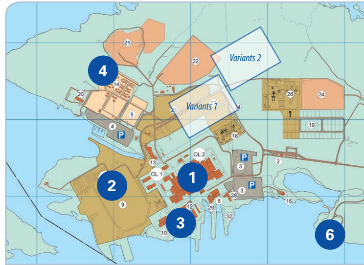
3.attēls. Olkiluoto atomelektrostācijas plāns. Tajā redzami esošie kodolreaktori OL1 un OL2 (1), celtniecības stadijā esošā reaktora OL3 būvlaukums (2), izlietotās degvielas glabātava (3), radioaktīvo atkritumu glabātava (4), izlietotās degvielas glabātava, pazemes pētniecības telpu būvlaukums (5) un apmeklētāju centrs (6). Šai plānā ir atzīmētas iespējamās jaunā atomelektrostacija atrašanās vietas.
