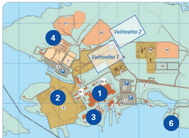
Kuva 3. Olkiluodon voimalaitosalue. Kartalla näkyvät mm. nykyiset ydinvoimalaitosyksiköt OL1 ja OL2 (1), rakenteilla olevan ydinvoimalaitosyksikön OL3-työmaa (2), käytetyn polttoaineen välivarasto (3), voimalaitosjätteen loppusijoitustila (4), käytetyn polttoaineen loppusijoitus, maanalaisen tutkimustilan työmaa (5) ja vierailukeskus (6). Karttaan on merkitty lisäksi uuden voimalaitosyksikön vaihtoehtoiset sijoituspaikat.
