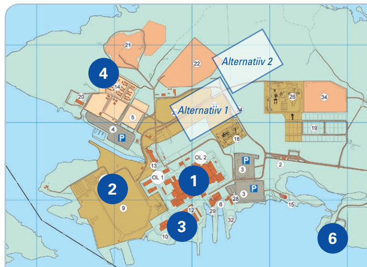
Joonis 3. Olkiluoto tuumajaama territoorium. Kaardil on näha mh. praegu- sed tuumajaamad OL1 ja OL2 (1), ehitamisel oleva tuumajaama OL3 objekt (2), kasutatud kütuse ladu (3), tuumajaamajätmete lõppladus- tamisruumid (4), kasutatud kütuse lõppladu, maa-aluse uurimisruumi ehitusobjekt (5) ja külastuskeskus (6). Kaardile on märgitud lisaks ka uue tuumajaama alternatiivsed asukohad.
