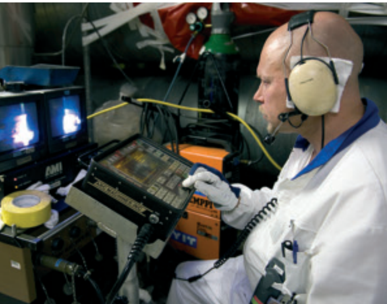
Orbit-hitsausta hallitaan erillisen ohjauspäätteen ja kameroiden avulla.
