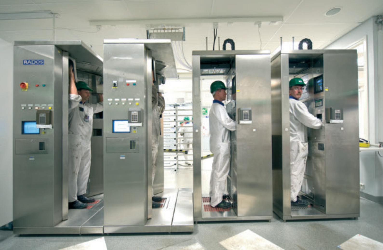
Radioaktiivisen kontaminaation mittausta kaksoismonitoroinnilla.
