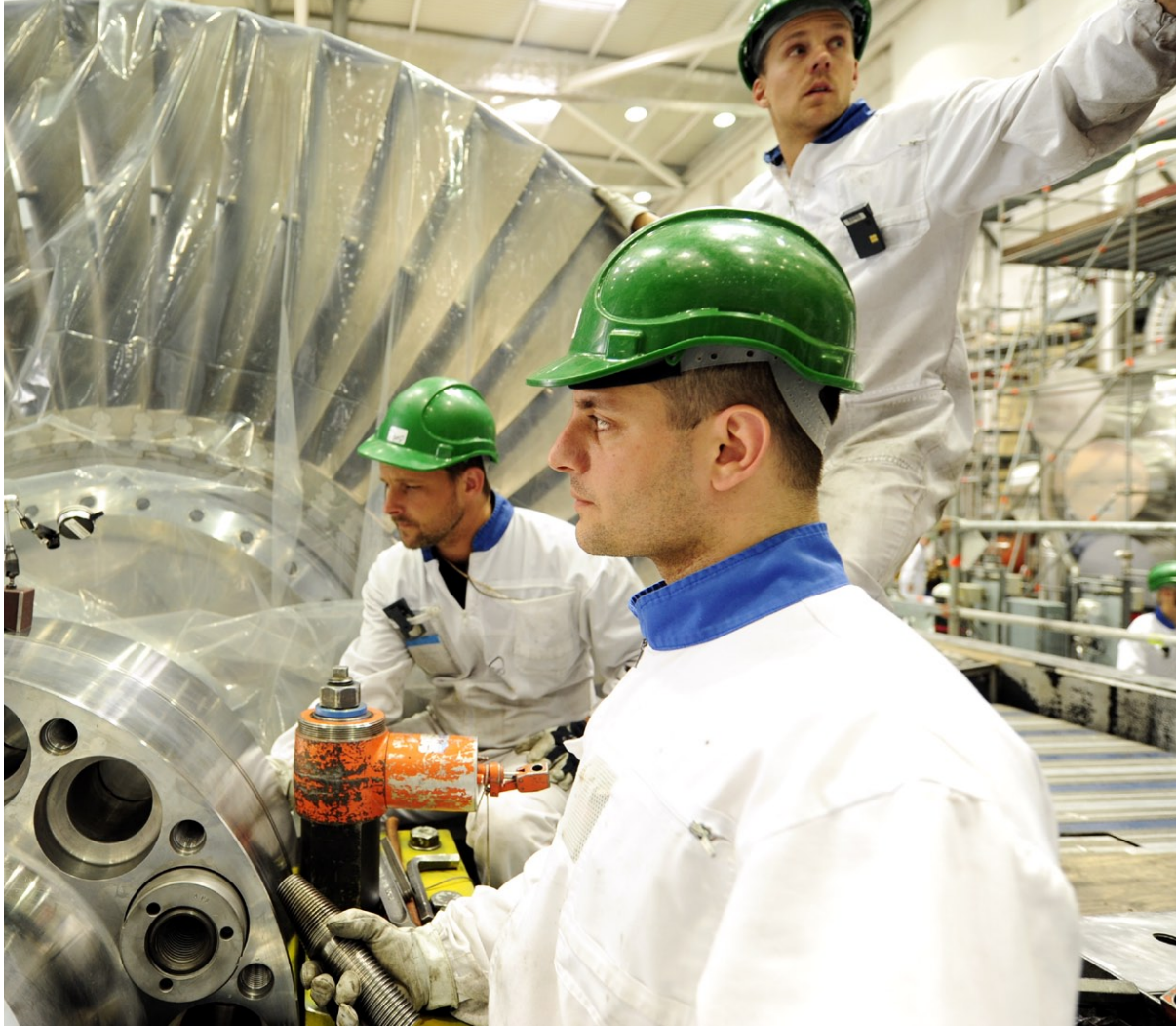
Yläkuva: Matalapaineturbiinin akselin kytkintä asennetaan. Alakuva: Magnetointikoneen akselia tarkastetaan.
