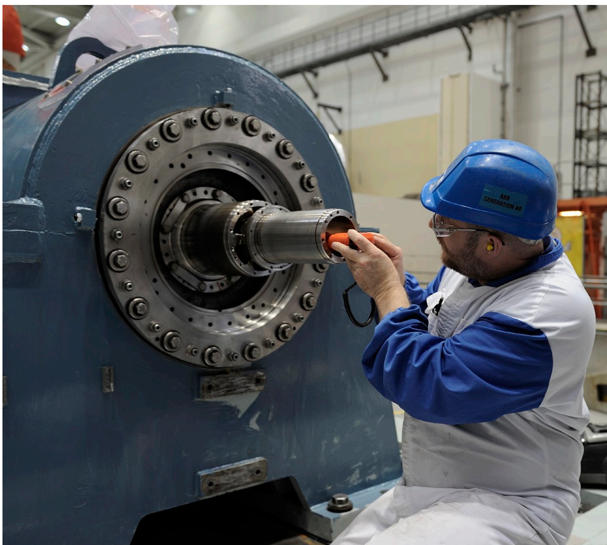
Yläkuva: Matalapaineturbiinin akselin kytkintä asennetaan. Alakuva: Magnetointikoneen akselia tarkastetaan.
