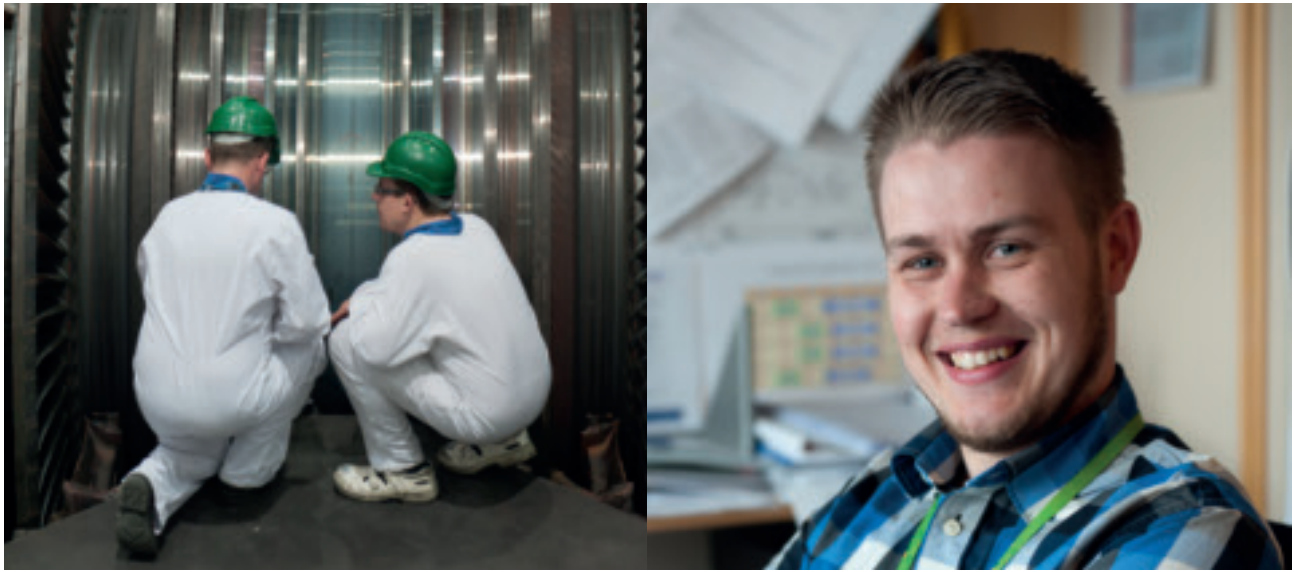
Matalapaineturbiinien juoksu- ja johtosiipien välisten välysten tarkastus.
