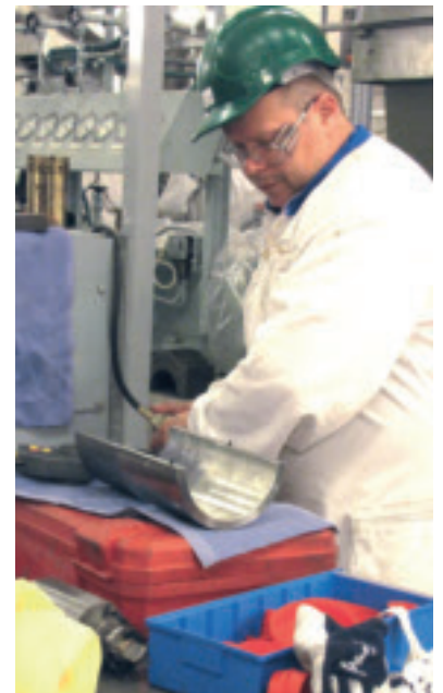
Syöttövesipumppujen liukulaakerit tarkasti Harri Kallio.
