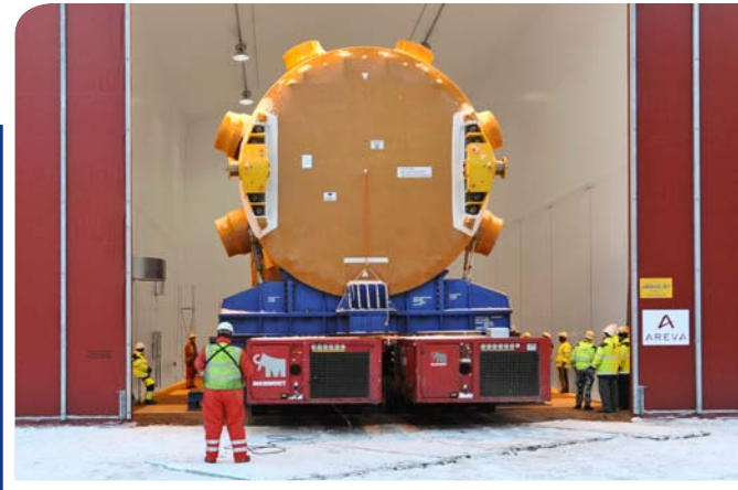
Reaktorilaitoksen reaktoripaineastia tuli Olkiluotoon merikuljetuksena vuoden 2009 alussa.
