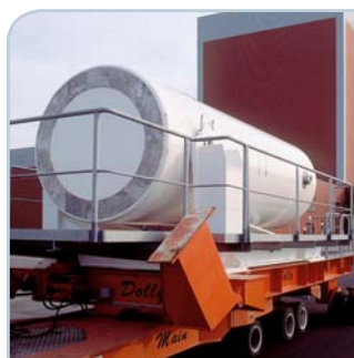
Käytetty polttoaine kuljetetaan välivarastoon pallografiittiraudasta valetulla siirtosäiliöllä.
