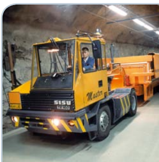
Jätteet kuljetetaan Voimalaitosjäteluolaan säteilysuojalla varustetulla ajoneuvolla.
