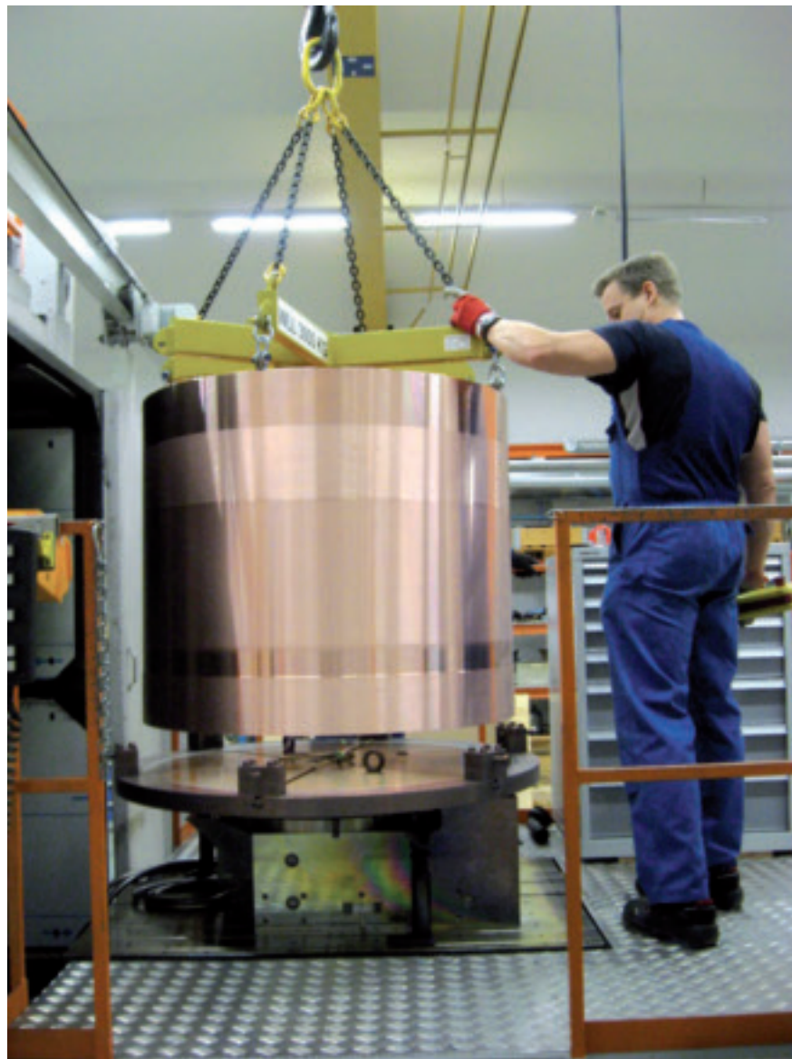
Kapseliputken asennus hitsauskammion pyörityspöydälle kannen hitsauskoetta varten.
