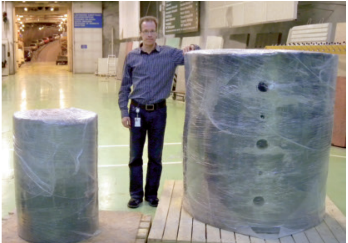
Isostaattisesti puristettuja bentoniittilohkoja VTT:n tutkimuslaboratoriossa.
