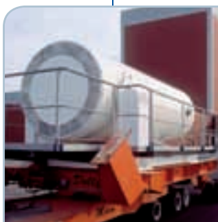
Käytetty polttoaine kuljetetaan välivarastoon pallografiittiraudasta valetulla siirtosäiliöllä.
