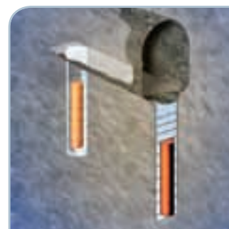
Loppusijoitusta edeltävät huolelliset tutkimukset muun muassa kallioperän eheydestä ja geologisesta vakaudesta. Käytetty polttoaine loppusijoitetaan noin 420 metrin syvyyteen kuparirautakapsleissa.
