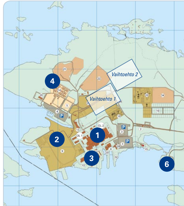
Kuva 3. Olkiluodon voimalaitosalue. Kartalla näkyvät mm. nykyiset ydinvoimalaitosyksiköt OL1 ja OL2 (1), rakenteilla olevan ydinvoimalaitosyksikön OL3:n työmäärä (2), käytetyn polttoaineen välivarasto (3), voimalaitosjätteen
