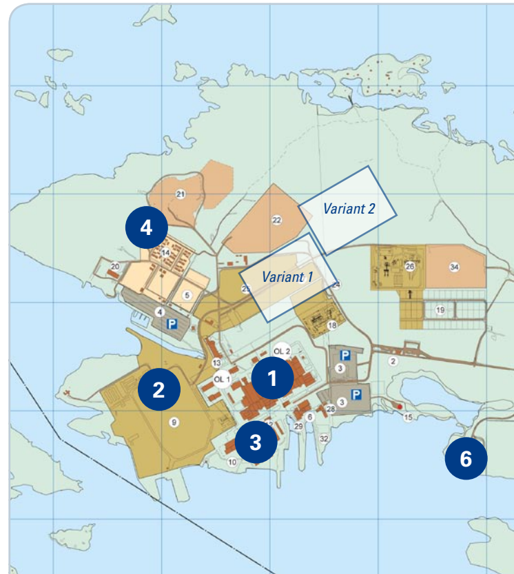
Joonis 3. Olkiluoto tuumajaama territoorium. Kaardil on näha praegused tuumajaamaüksused OL1 ja OL2 (1), ehitamisel oleva tuumajaamaüksuse OL3 ehitusobjekt (2), kasutatud kütuse vaheladu (3), tuumajaamajäätmete
