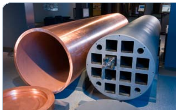
Kuva 9-7 Loppusijoituskapseli koostuu kuparisesta ulko-osasta sekä pallografiittirautaisesta sisäosasta. Loppusijoituskapselin sisälle mahtuu 12 OL1:n ja OL2:n käytettyä polttoainepussia kuten kuvassa tai neljä OL3-tyyppisen EPR:n polttoainepussia.
