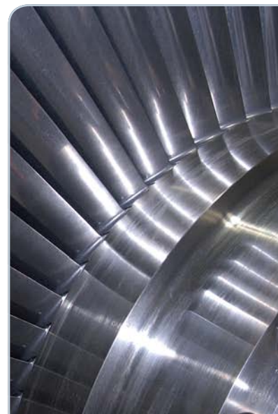
T&K-toiminnan avulla kehitämme laitosyksiköitä jatkuvasti. Uusimme seuraavissa vuosihuolloissa matalapaineturpiinit, minkä ansiosta tuotantoteho nousee 25 MW:lla.
