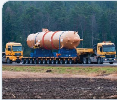
OL3 on painevesilaitos, jonka reaktorityyppi on EPR (European Pressurized water Reactor). Kuvan paineistin pitää primääripiirin paineen niin korkeana, ettei vesi pääse kiehumaan, vaikka se on yli 300 asteista.
